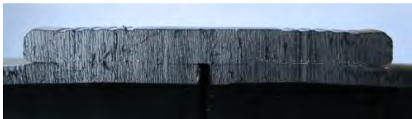
Abbildung 10: Elektromuffen-Schweißung; Rechts: Querschnitt durch die Schweißnaht (Bruckner, 2015).
