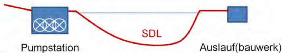
Abbildung 26: Pumpengestützter Abwassertransport durch die SDL.
