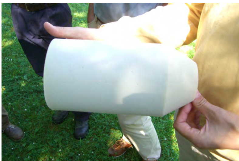
Abbildung 64: Für die Reinigung verwendeter Schaumstoffmolch.
