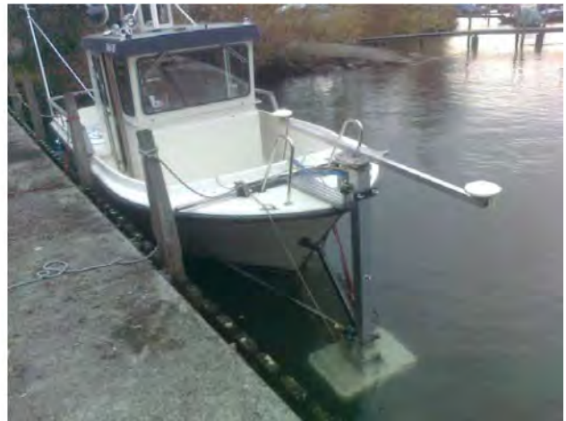
Abbildung 50: Links: Funktionsschema des Fächerecholotes. Rechts: Das Kongsberg EM 2040 Fächerecholot montiert am Bug eines Forschungsschiffes (Anselmetti, 2015).
